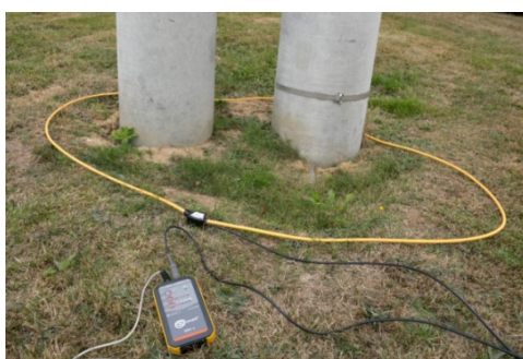
Rys. 8. ERP-1 na słupie wirowym i przy pomiarze słupa kratowego
